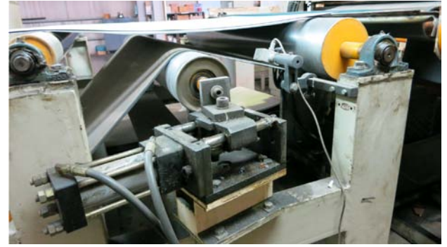
Konveyör Guider (Hidrolik) yer karosu makinesi üzerinde kullanılmaktadır.
